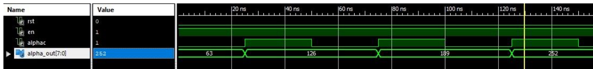
Figure III.5: Chronogrammes de simulation du générateur de rapport cyclique configurable
