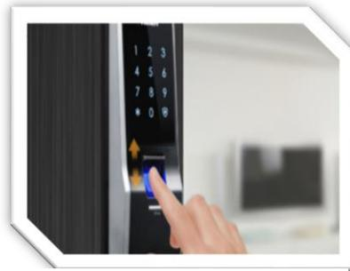
Figure I. 4 : une serrure biométrique.
