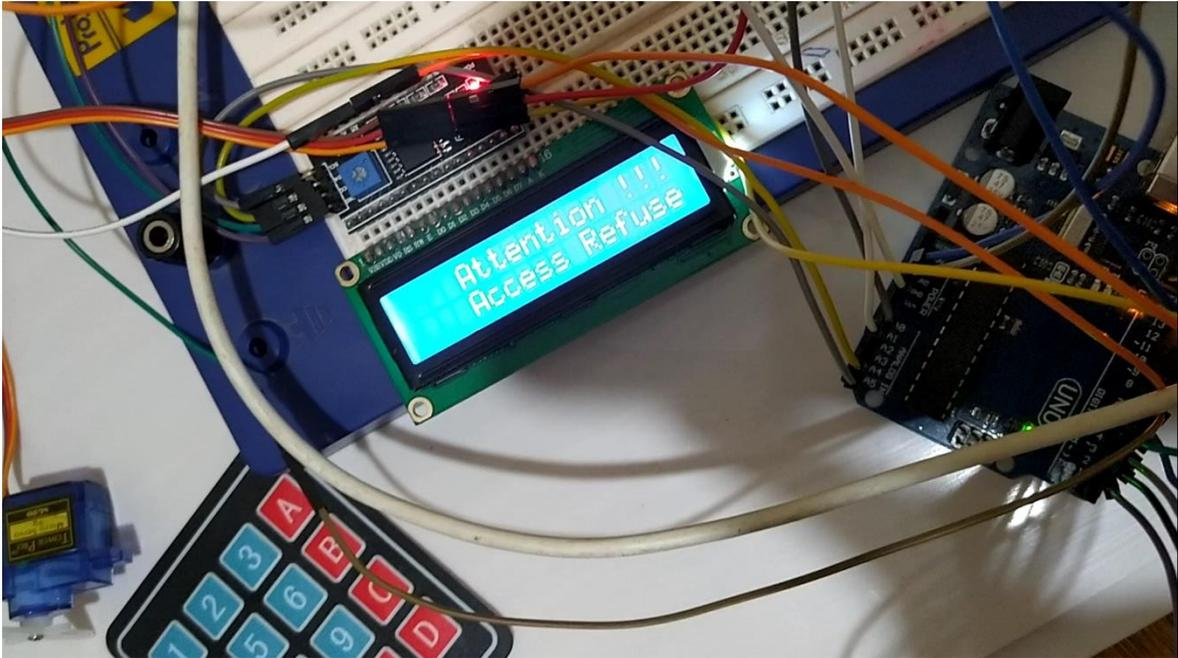
Figure III. 25: le système en mode d'alarme.
