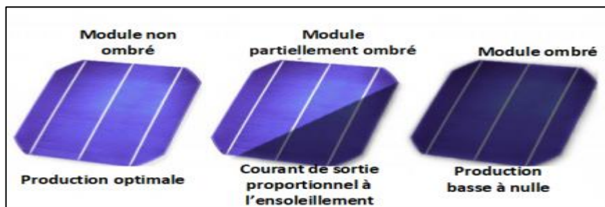
Figure 1.9 : Exemples d'ombrage sur modules PV
