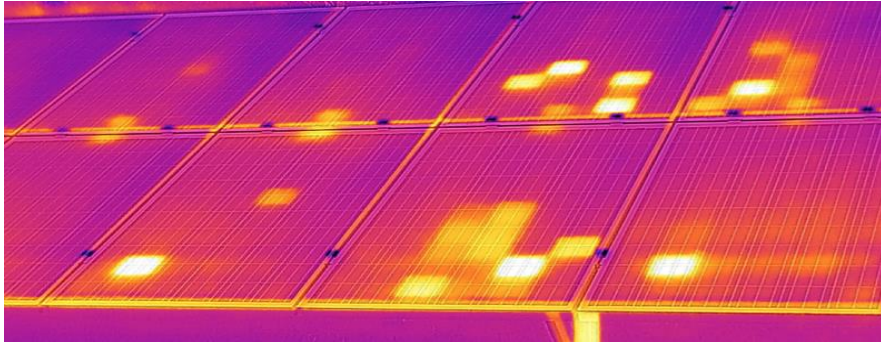
Figure 3-3 : Imagerie thermique de défaut dans la surface de Panneaux.
