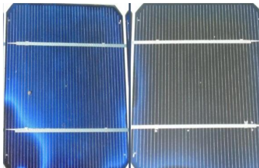
La détérioration de la peinture antireflet
