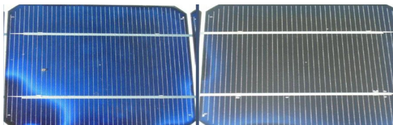
Figure 2-15 : La détérioration de la peinture antireflet
