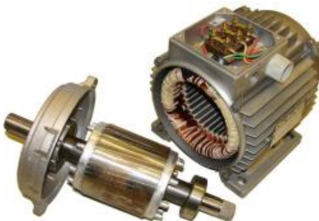
Figure I.1 : photo d'une MAS
