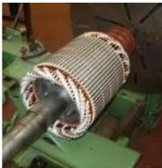
Figure I.3 : photo d'un rotor bobiné d'une MAS
