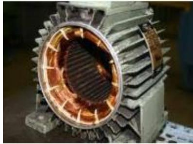
Figure I.2 : photo d'un stator d'une MAS
