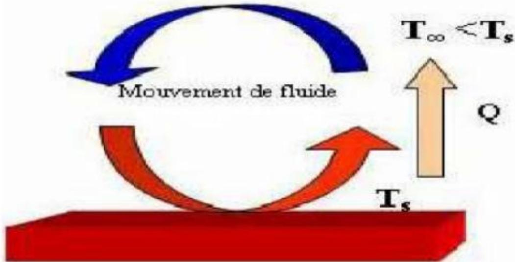
Figure I. 3: Schéma de transfert de chaleur par convection.
