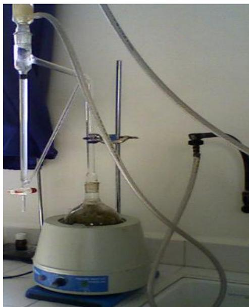
**Figure 2.7:** Appareil d'hydrodistillation de type clevenger (Originale, 2018)
