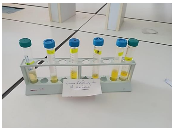
Figure 2.c : Gamme d'étalonnage de B-carotène.
