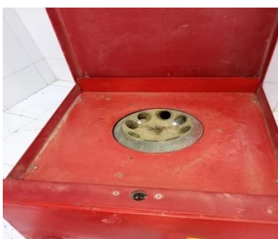
Figure 3g : Centrifugeuse Gerber pour la détermination du taux de matière grasse du lait avec et sans l'extrait.
