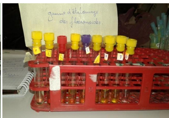
Figure 2.f : Gamme d'étalonnage des flavonoïdes.
