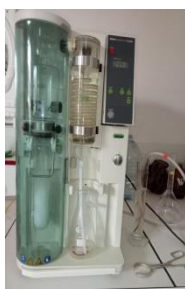
Figure 3f : Etapes de la détermination du taux de l'azote protéique dans le lait en absence et en présence de l'extrait.
