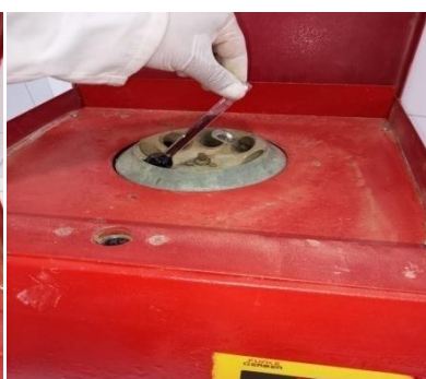
Figure 3g : Centrifugeuse Gerber pour la détermination du taux de matière grasse du lait avec et sans l'extrait.
