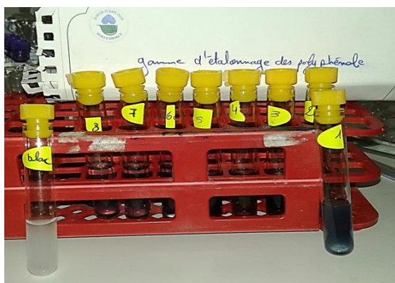
Figure 2.e : Gamme d'étalonnage des polyphénols.
