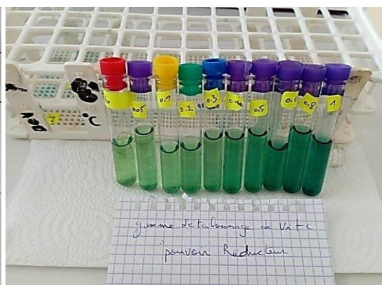
Figure 2.d : Gamme d'étalonnage de vitamine C.
