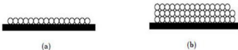
**Figure II.2 :** Arrangement des couches d'adsorbat : (a) en monocouche, (b) en Multicouches
