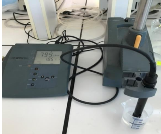
Figure 7. Conductimètre « inolab cond 7110 ».
