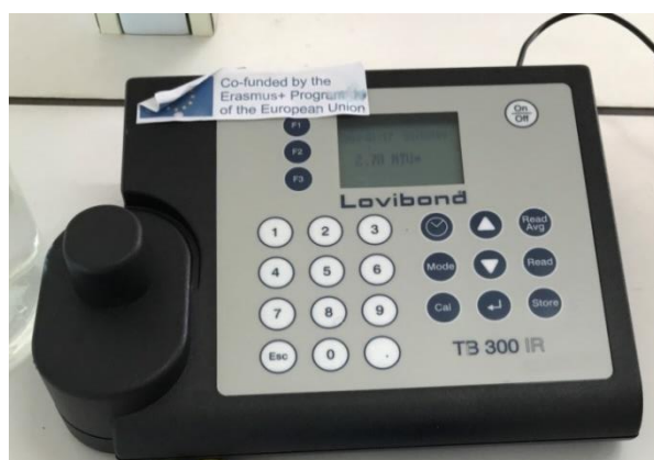
Figure 6. Turbidimètre TB300 IR.
