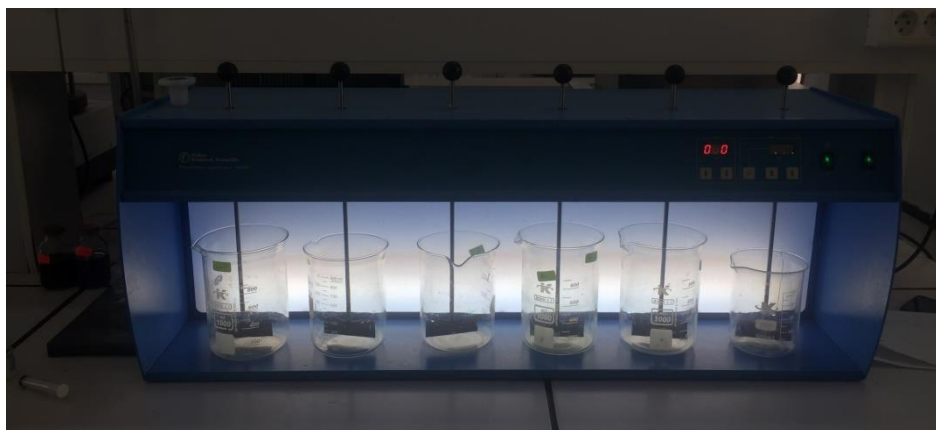
Figure 5 : Jar Test « Fisher Bioblock Scientific » Type 10408.
