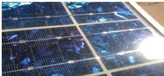
*Figure (I.6): Cellule au Silicium Poly-cristallin.*
