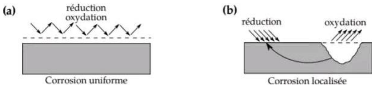
Fig. I.4 : (a) La distribution homogène des demi-réactions anodiques et cathodiques génère une corrosion uniforme. (b) La localisation d'une des demi-réactions anodique ou cathodique génère une corrosion localisée [56].
