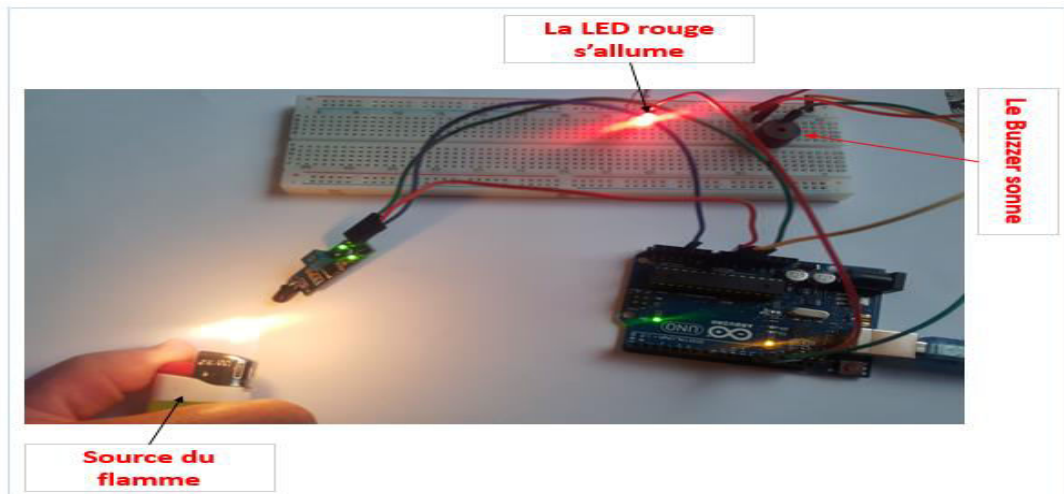
Figure IV.32: La conception du système en cas des incendies
