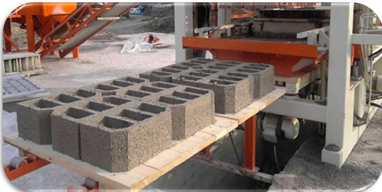
Figure II.2 : fabrication des hourdis. [1]
