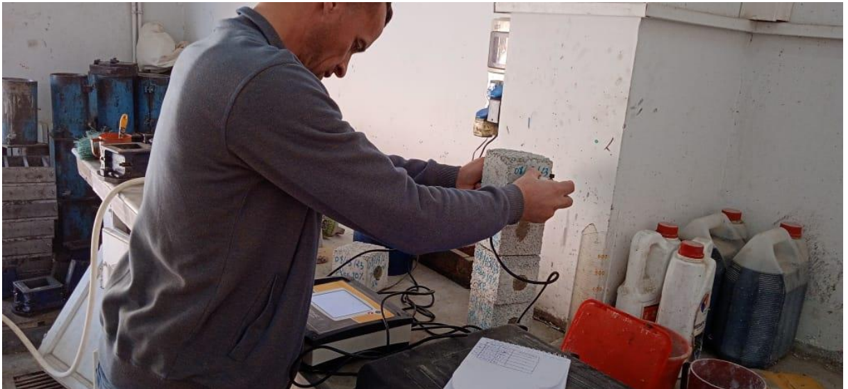
Figure III.14 : Essai d'auscultation dynamique par ultrasonique.
