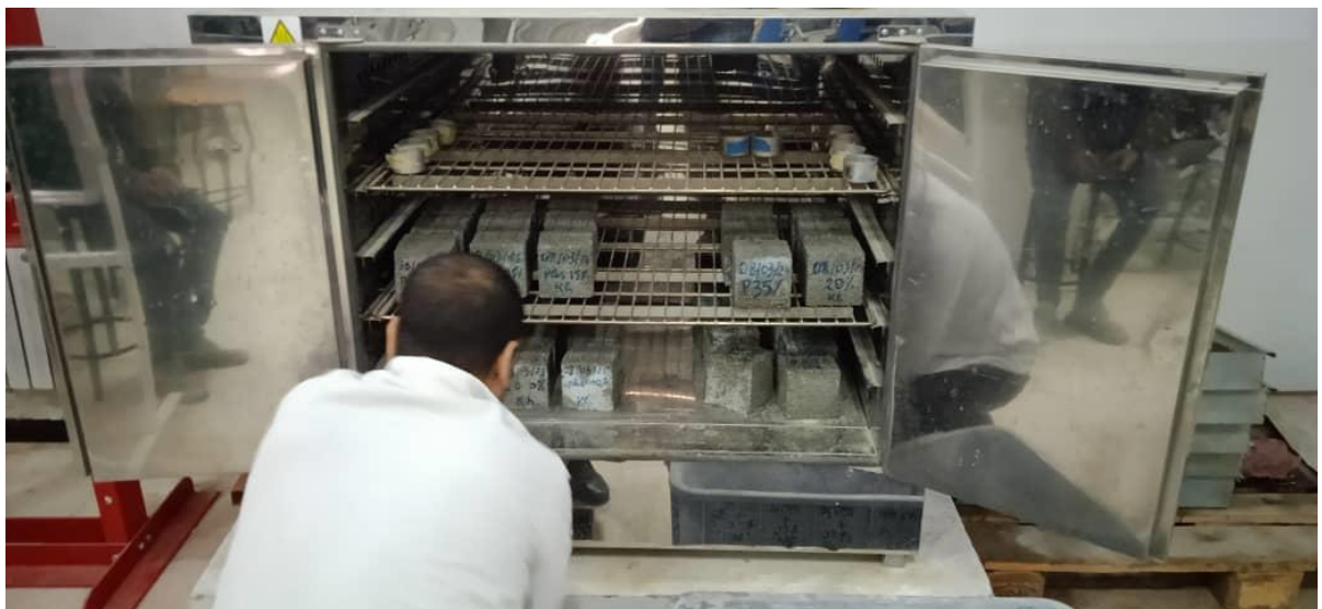
Figure III.15 : Séchage les éprouvettes à 71°C (essai de mouillage/séchage).
