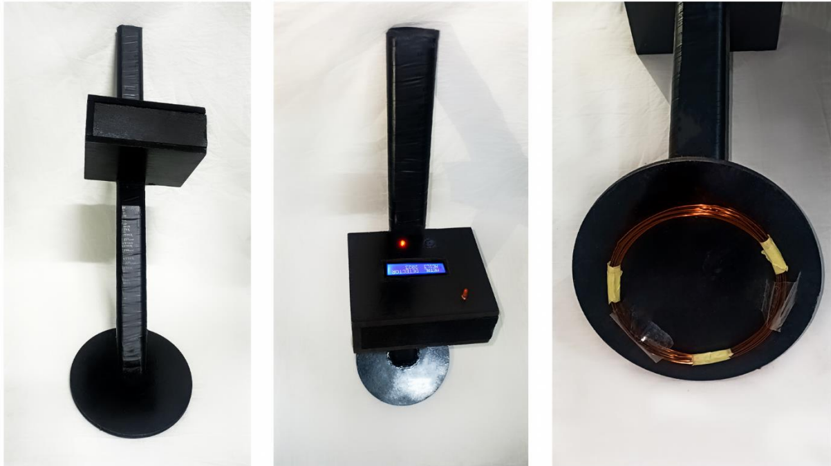
Figure II.5 : Réalisation du détecteur de métaux produit fini.
