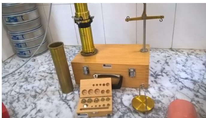
Photo 01 : Le Nilema-litre utilisé pour mesurer le poids spécifique.
