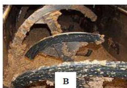
Figure 08 : Processus de malaxage des olives. (A) Installation de bacs de malaxage en parallèle ;( B) Pâte d'huile en mélange à l'intérieur d'un malaxeur (COI, 2015).
