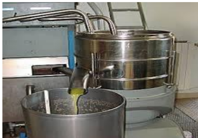
Figure 10 : Sortie de l'huile par la centrifugeuse
