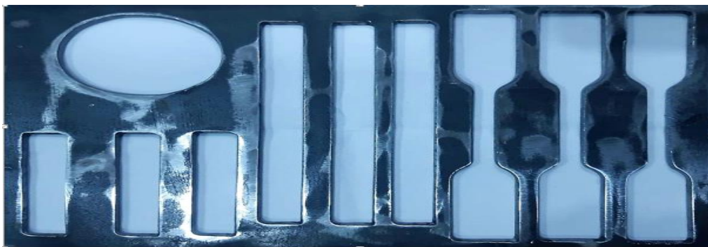
Figure 2.10 : moule sur la norme ASTM d'essais physiques et mécaniques utilisant pour préparés des éprouvettes
