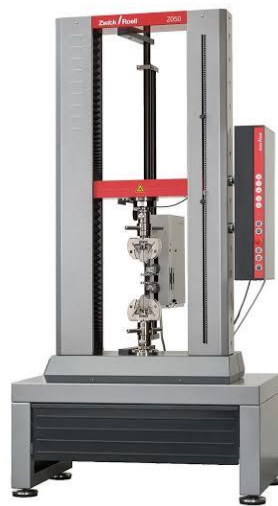
Figure 2.15 : Machine d'essais traction et flexion d'universelle Zwick/Roell ZD60 de capacité 5 kn
