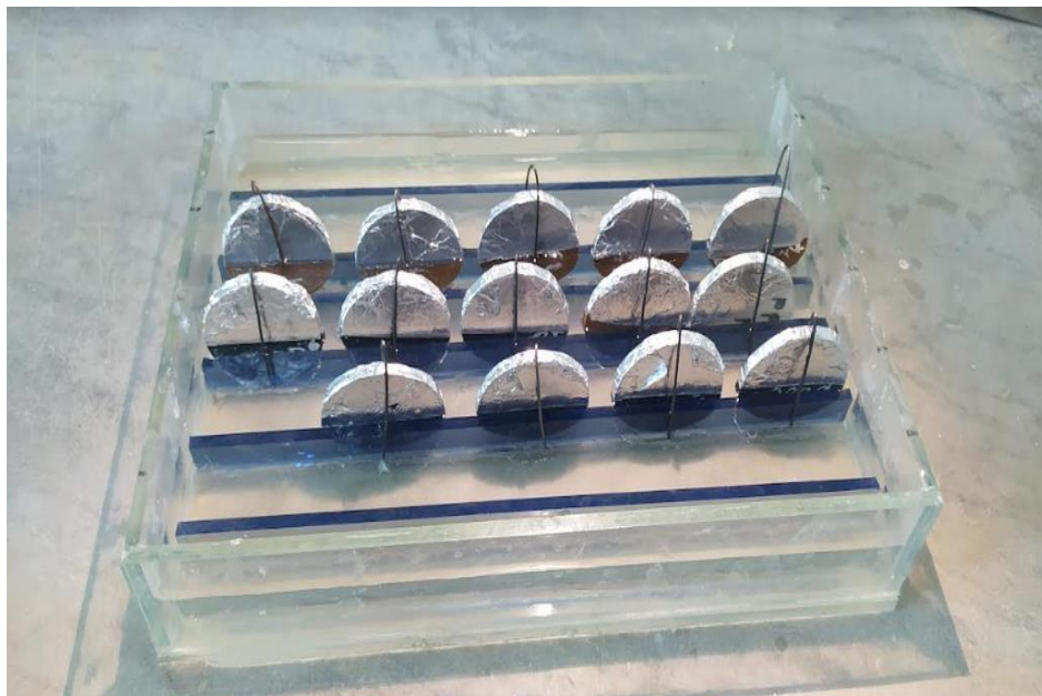
Figure 2.17 : Absorption d'eau par capillarité
