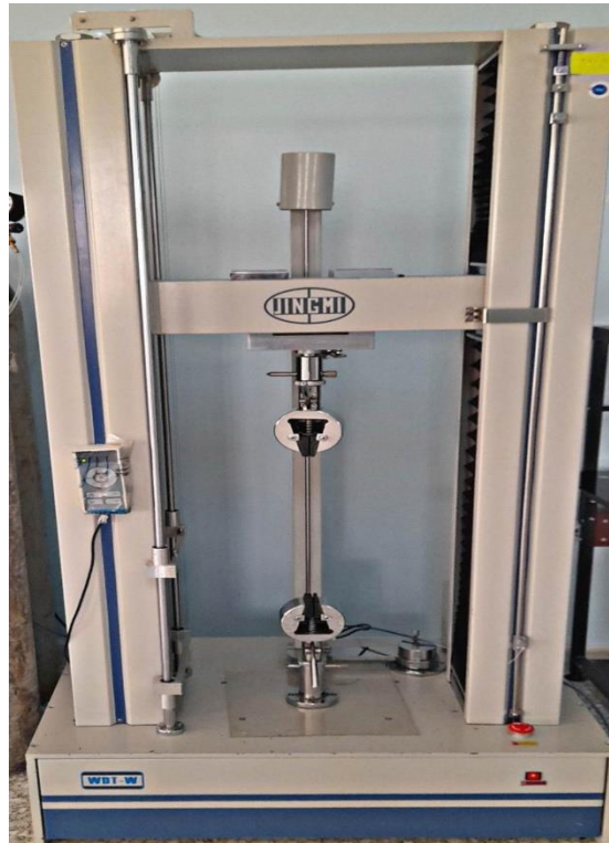
Figure 2.14 : Machine d'essai universelle JINGMI WDR-W de capacité 20 kN
