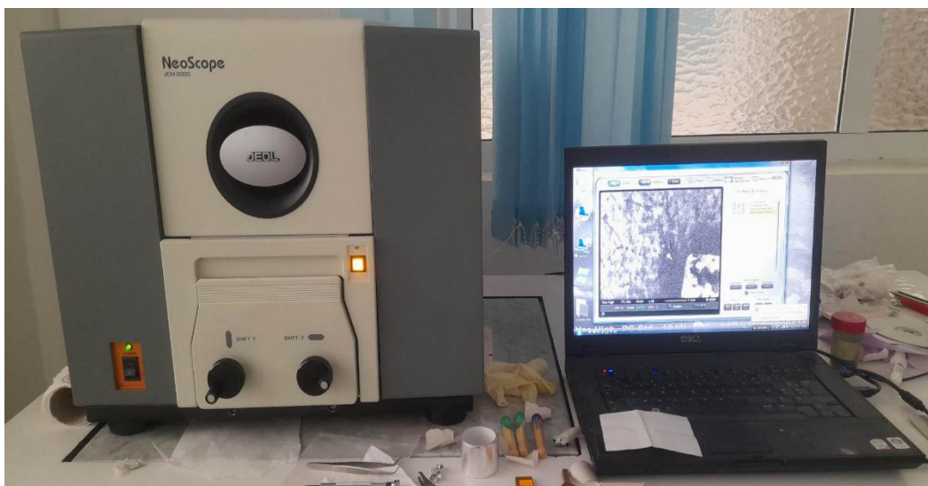
Figure 2.19 : Microscope électronique à balayage (MEB)
