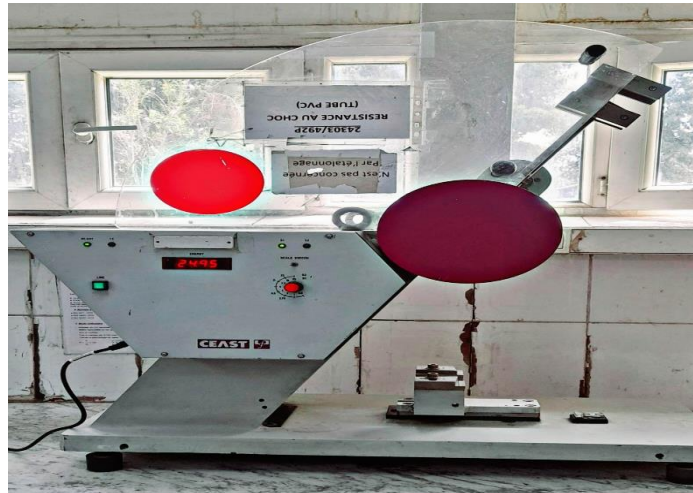
Figure 2.16 : Machine Mouton pendule, modèle CEAST 9050 utilisée pour l'essai d'impact
