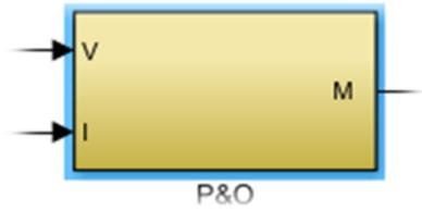
(a) bloc schématique du commande PPM
