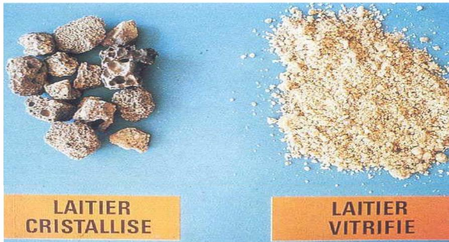
**Figure1.1.** Laitier cristallisé et vitrifié de haut fourneau.
