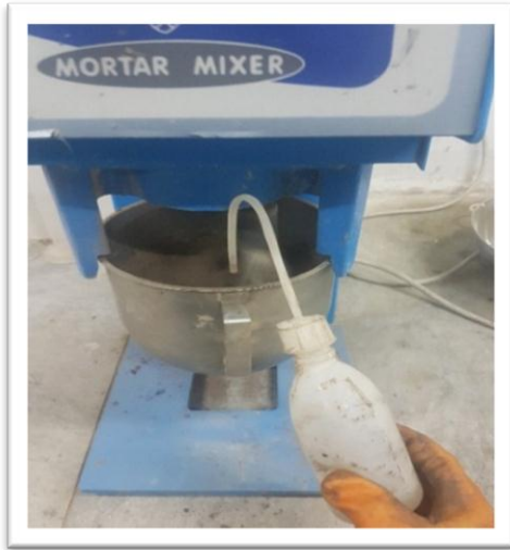
Figure 2.14: Malaxage du mélange avec l'eau
