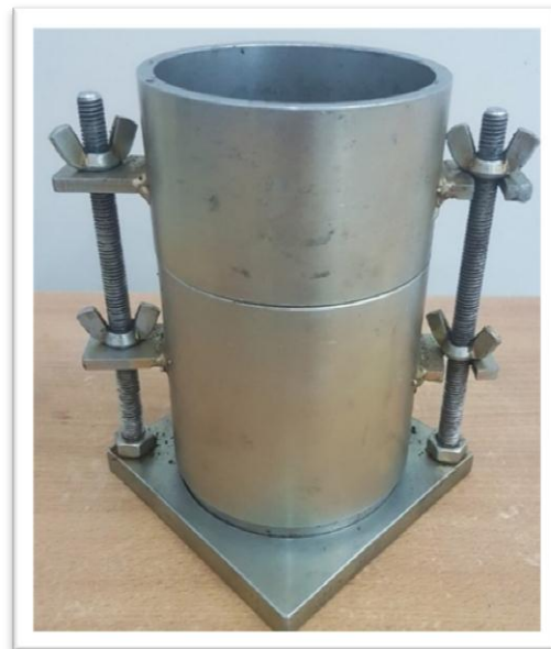
Figure 2.9: Moule utilisé pour la fabrication des blocs
