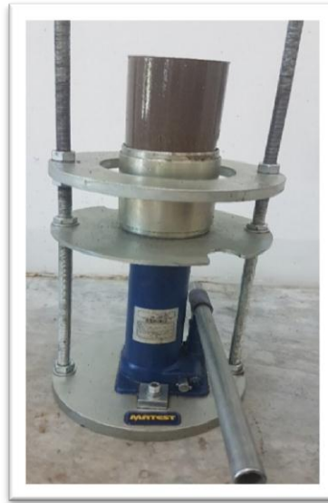
Figure 2.17: Démoulage de bloc
