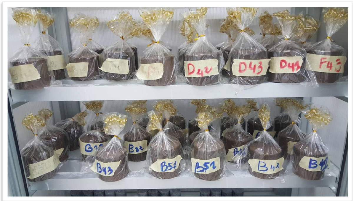
Figure 2.19: Conservation des blocs au laboratoire
