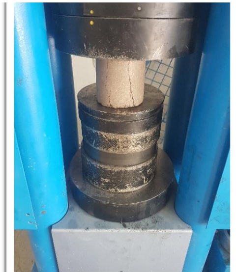
Figure 2.20: Dispositif d'essai de compression sur les échantillons de BTC
