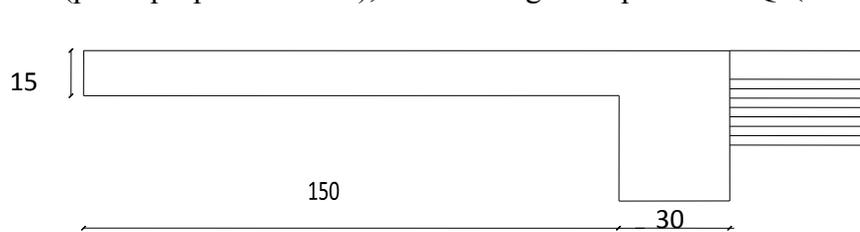
**Figure III-3 :** Présentation des dimensions du balcon.
