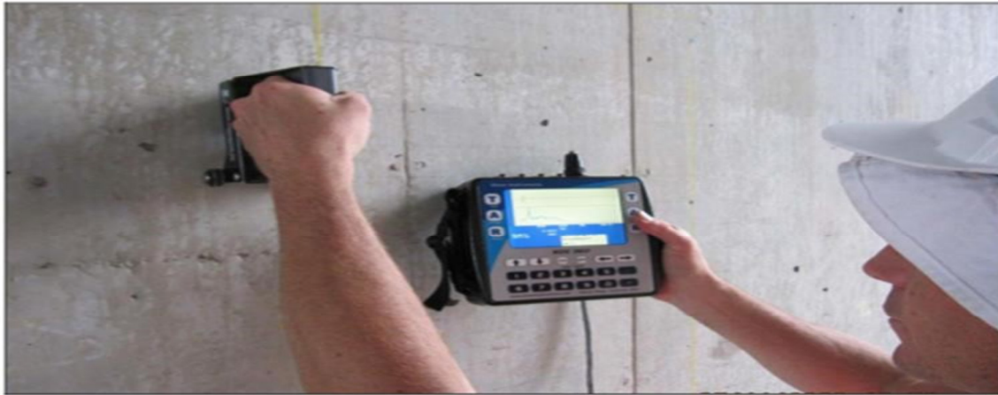
Figure 1. 14 : Test Choc-Echo avec appareil Olson's NDE 360. [18]
