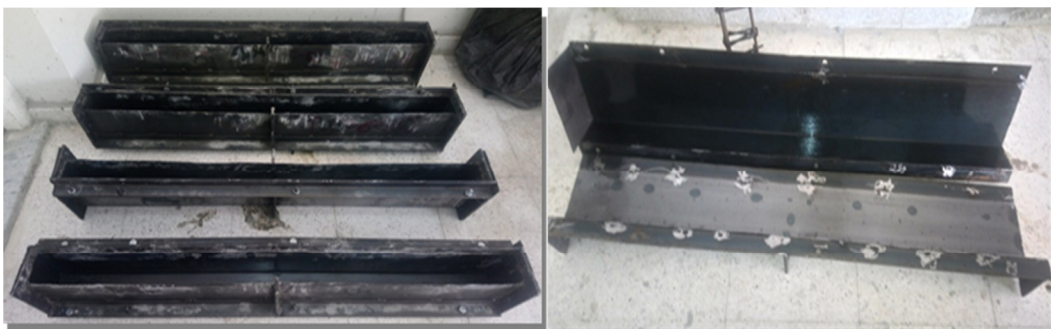
Figure 1. 18 : Coffrage des poutres. [1]
