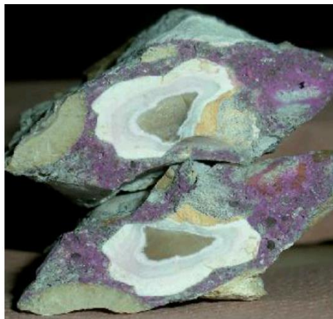
Figure 2. 8 Influence du carbonations sur le béton à base des granulats recyclés (Pereira et al., 2009).
