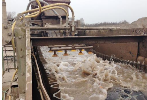
Figure 1. 4 Flottation du type « aquamator »
