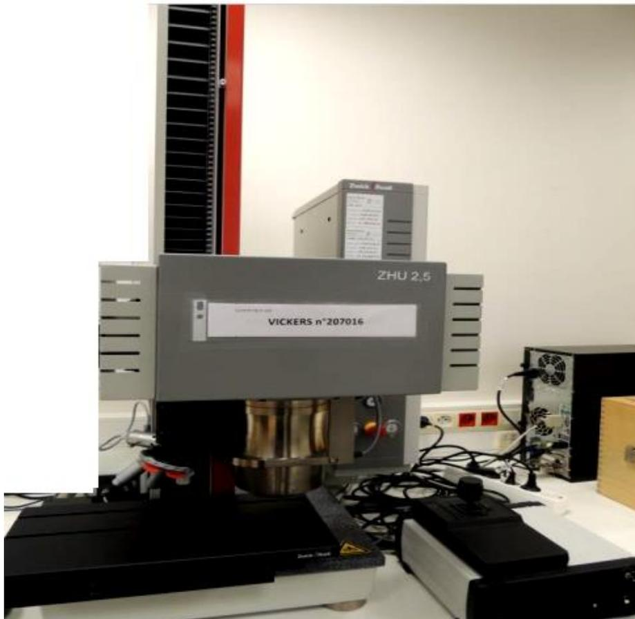
**Figure 3.4:** Machine d'indentation Zwick ZHU 2.5
