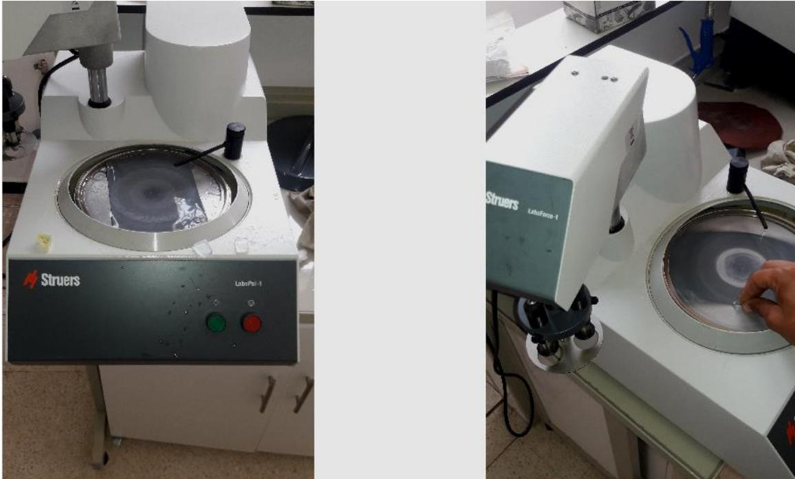
**Figure 3.2 :** Principe de rodage et polissage du matériau béton autoplaçant BAP par une polisseuse Struers
