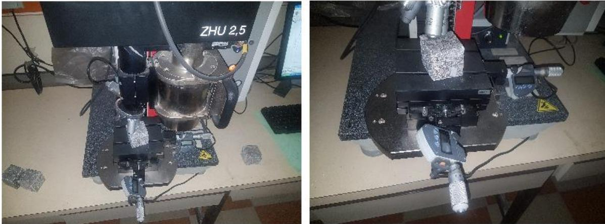
**Figure 3.7:** Plusieurs essais effectués sur le béton BAP au moyen d'indentation Zwick ZHU 2.5
