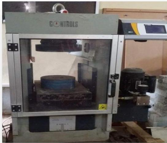
**Figure 1.13 :** Mesure de la résistance à la compression.
