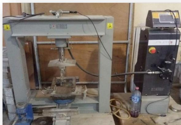
**Figure 1.14 :** Mesure de la résistance à la traction par flexion.
