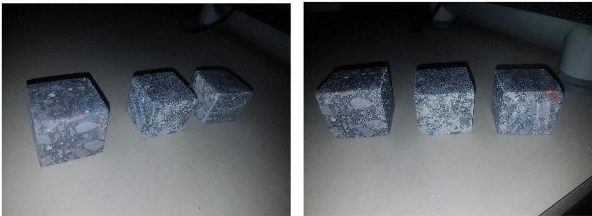
**Figure 3.3 :** Polissage du béton auto plaçant par des papiers abrasifs :
