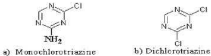
Figure I-7 : structures des colorants réactifs
