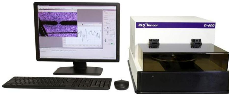
*Figure II.12 : Dispositif expérimental utilisé pour déterminer l'épaisseur (Profilomètre).*
