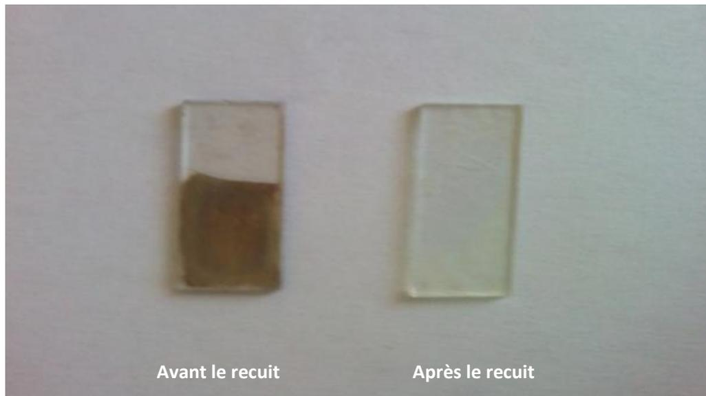
*Figure III.2: photographie des films d'oxyde de molybdène  $\text{MoO}_3$ .*
