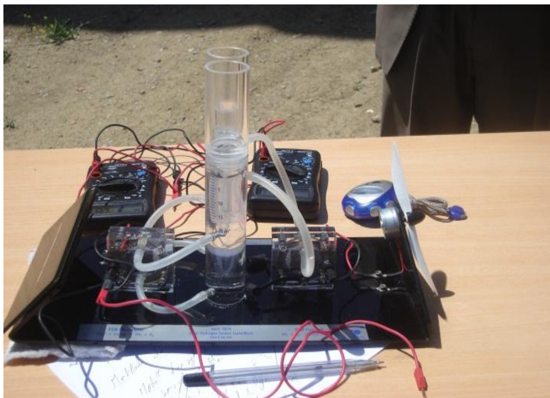
Figure IV-4.a : Prototypé de système solaire-hydrogène.
