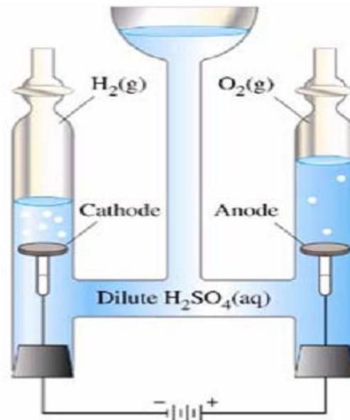
Figure III-1 : Principe de l'électrolyse [66].
