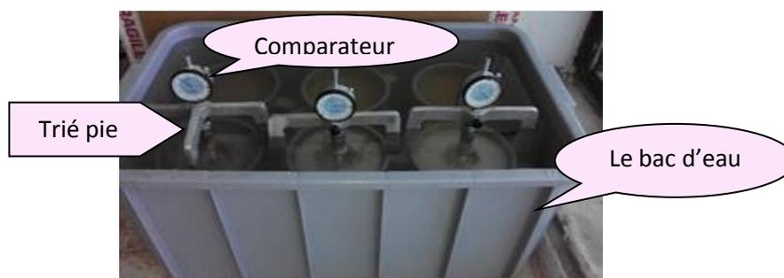
**Figure IV.42 :** Essai de tassement par le comparateur.
