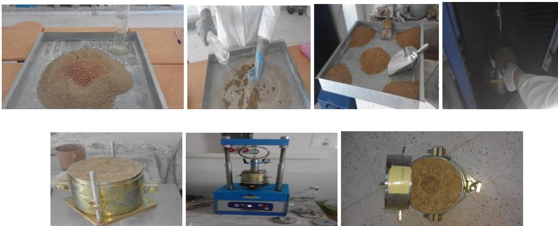
**Figure III.25** : Déroulement de l'essai –CBR.
