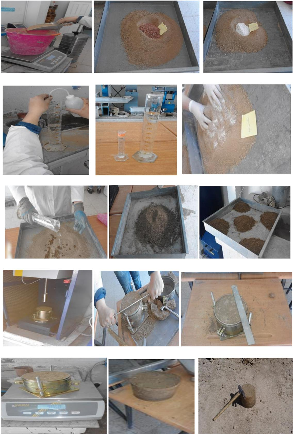
Figure III.19 : Déroulement de l'essai – Proctor.
