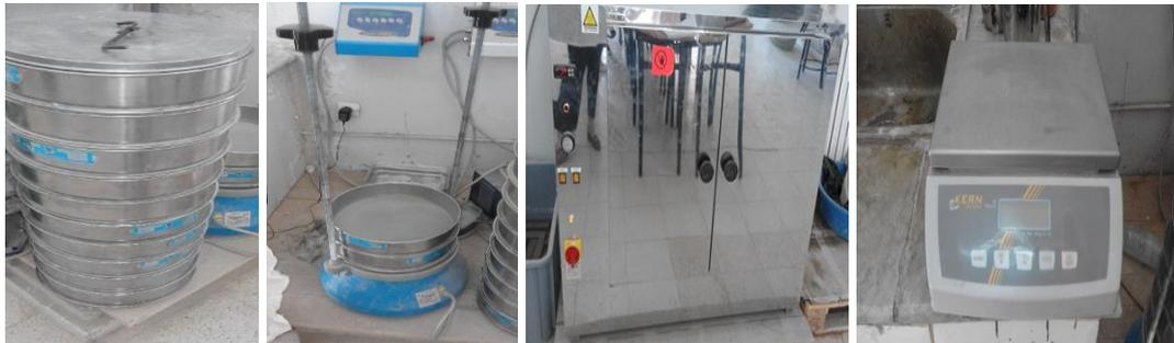
**Figure III.10** : Appareillage – essai granulométrique.
