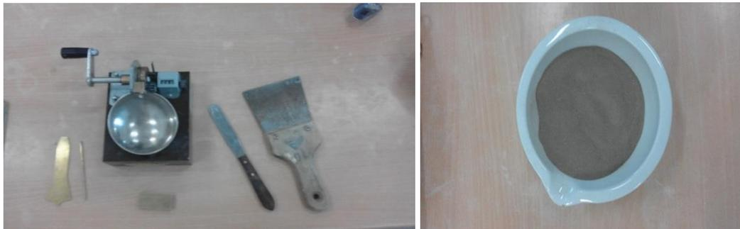
Figure III.12 : Appareil de Casagrande.
