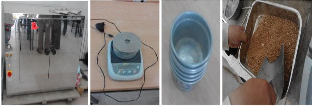
Figure III.8 : Appareillage –Teneur en eau (NF P 94-050)
