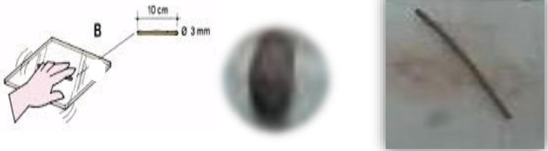
**Figure III.15** : Détermination de la limite de plasticité.
