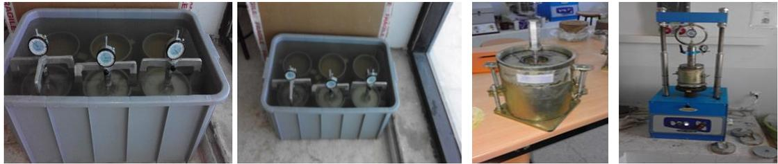
**Figure III.24** : CBR du sol traité en liant hydraulique après immersion.
