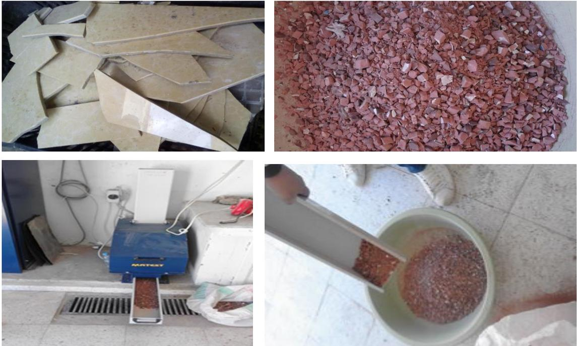
Figure III.5 : Concassage de céramique .
