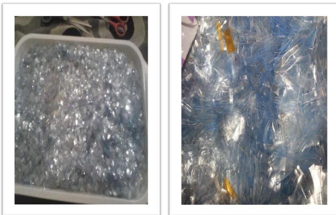
*Figure III.4. Plastique préparé sous forme des mailles de  $3 \times 3 \text{ mm}^2$  et  $10 \times 3 \text{ mm}^2$ .*
