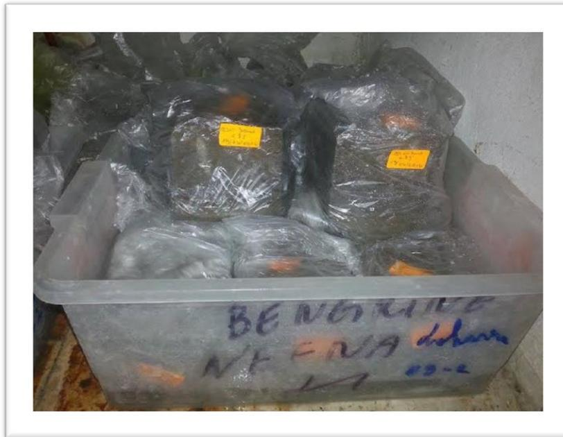
Figure III.10 : Des éprouvettes conservées à l'état humide
