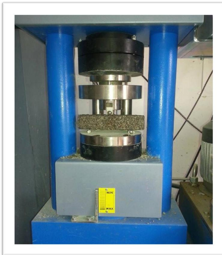
*Figure III .12: éprouvette placée dans la diapositive de la flexion*
