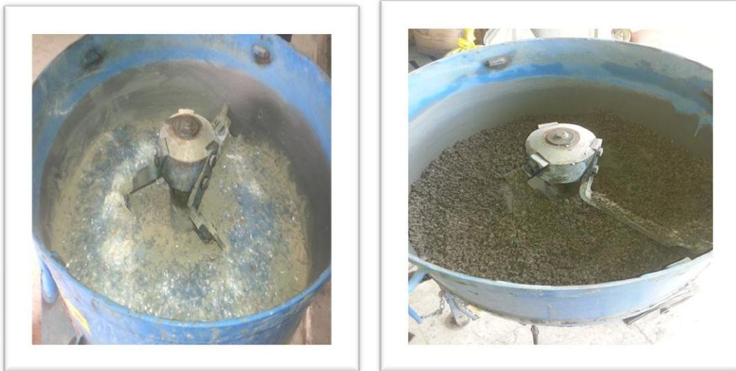
*Figure III.5: Béton de l'hourdis dans malaxeur*
