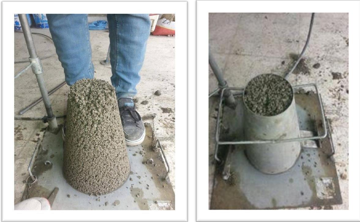
*Figure III .8.Mesure de l'affaissement.*
