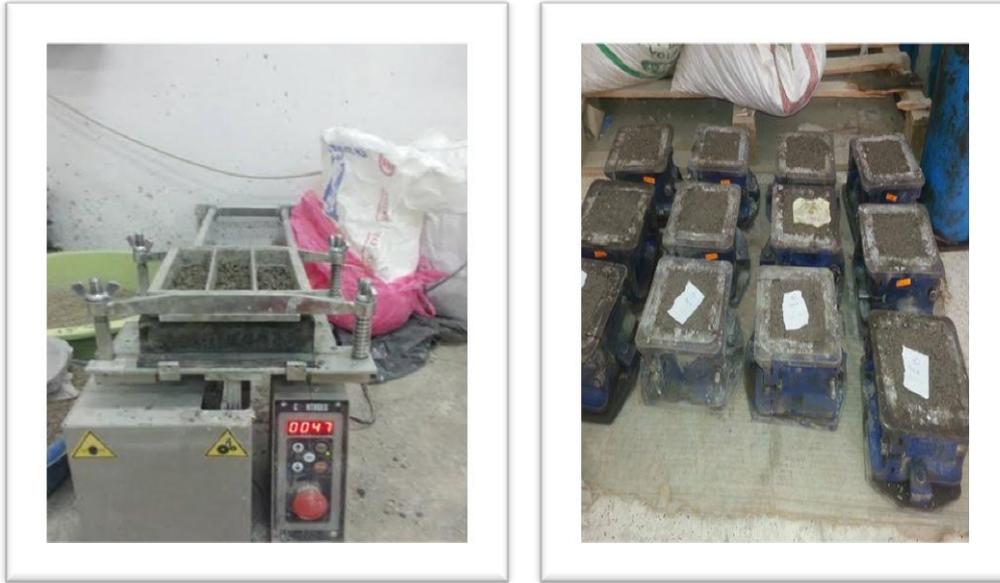
**Figure III.6:** éprouvette sur table à choc **Figure III.7 :**Des moules préparés
