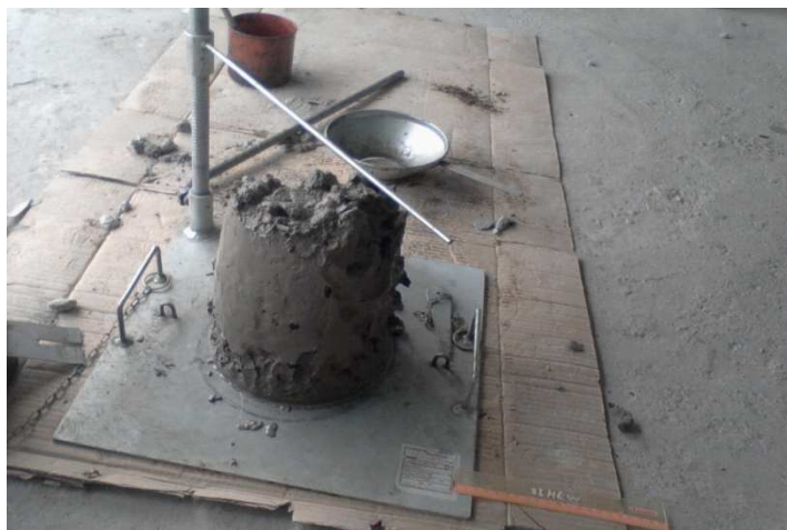
Photo III-1: L'essai d'affaissement au cône d'Abrams
