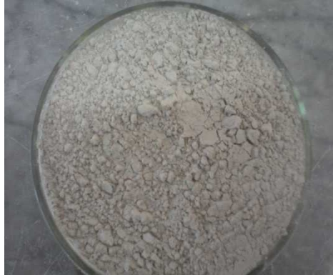
Photos II-4: laitier forme de poudre
