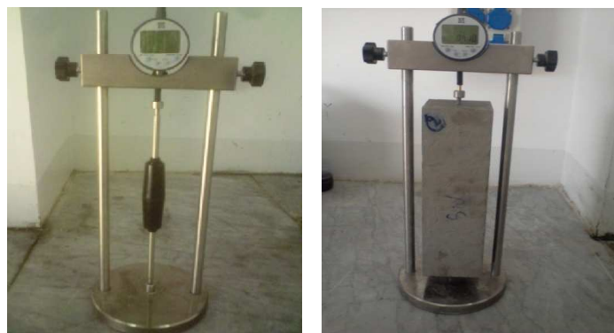
Photo II-13: Déformètre, éprouvette étalon
