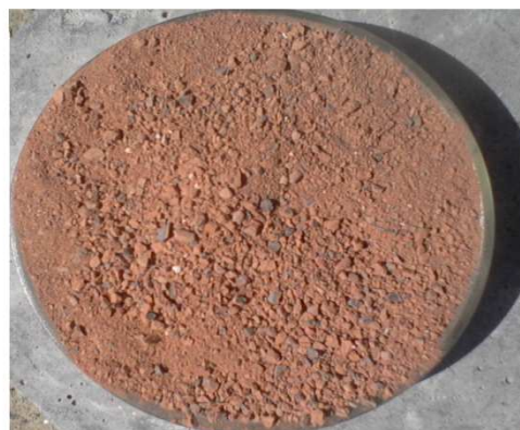
Photo II- 1: Sable recyclé (SDB) 0/5 produit par le concassage de béton.
