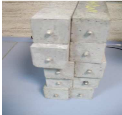
Photo II-12: éprouvette pour l'essai de retrait
