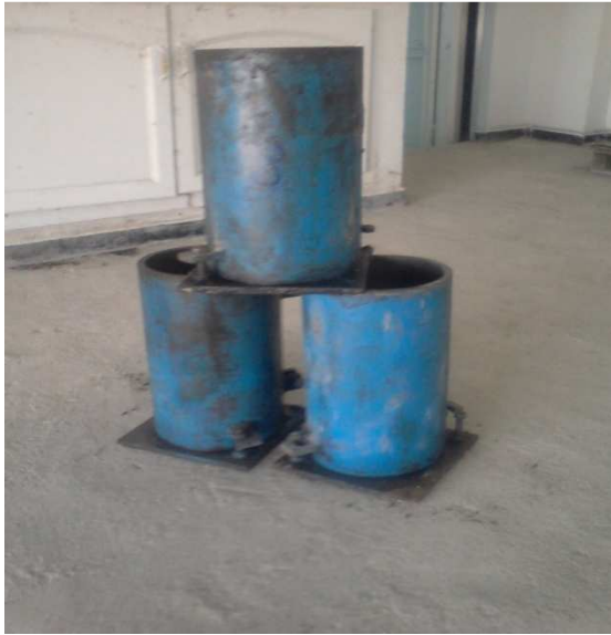
Photo 6 éprouvette (16X32) et (10X20) cm 3
