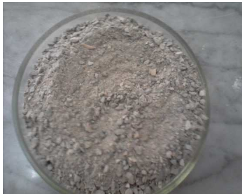
Photo II- 1: Sable recyclé (SDB) 0/5 produit par le concassage de béton.
