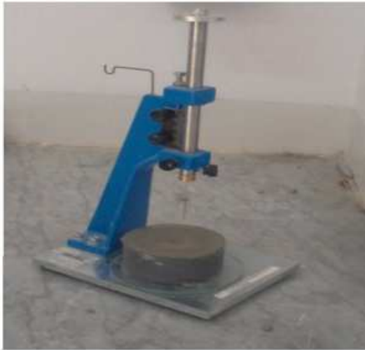
Photo 1: mesure le Temps de début de prise
