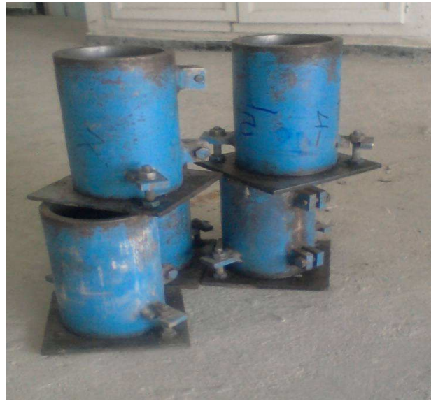
Photo 6 éprouvette (16X32) et (10X20) cm 3
