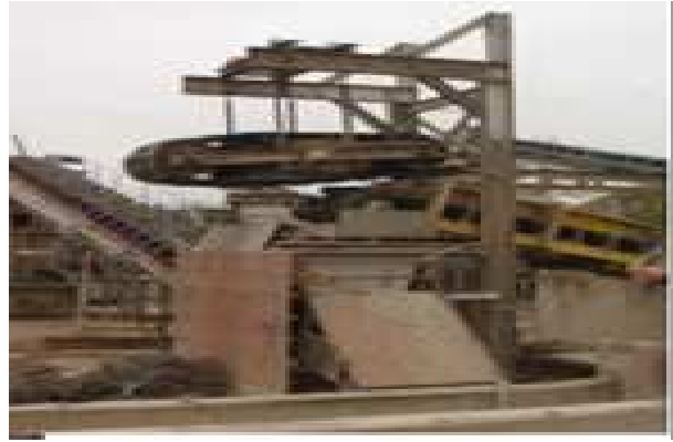
Photo I-2: Déferrailage magnétique par « Overband »
