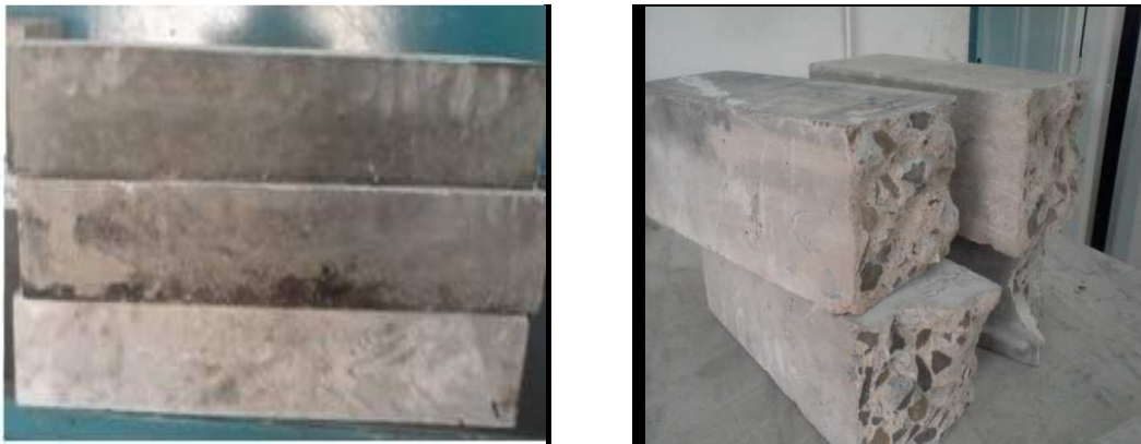
Photo III-2 : Eprouvettes prismatiques ( 10 \times 10 \times 50 ) \text{cm}^3
