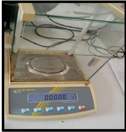
Balance de précision (kern Als220-4N) (Max220g, d=0.1 mg)
