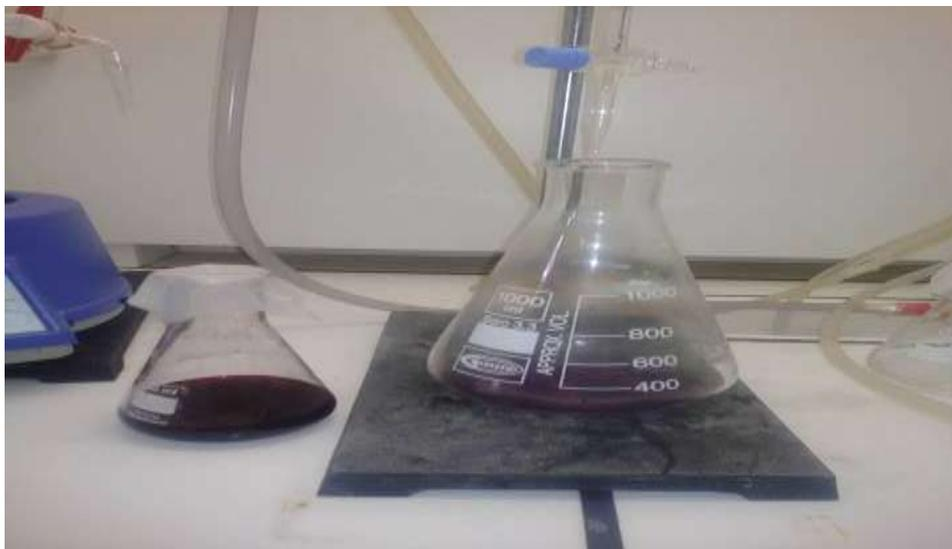
**Figure 27 :** Titration avec EDTA.
