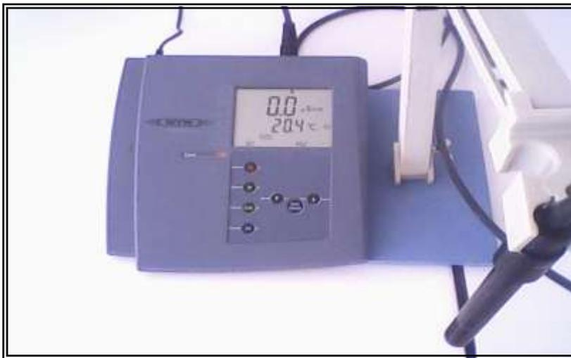
Figure 25 : Conductimètre.
