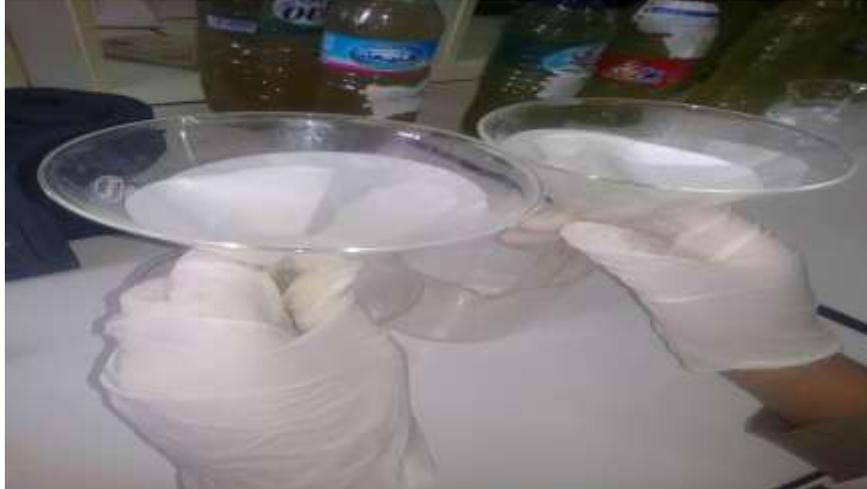
**Figure 26 :** Filtration de l'eau a échantillonné.
