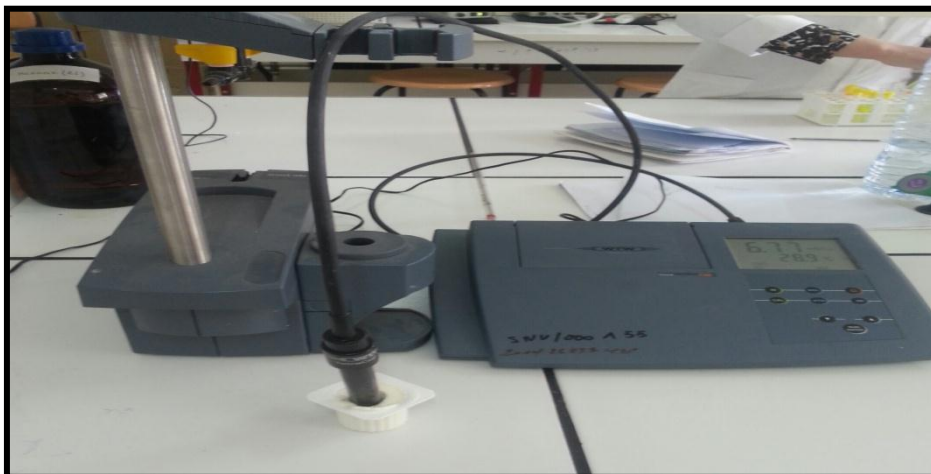
Figure N°19 A: la détermination de la conductivité (photo originale)
