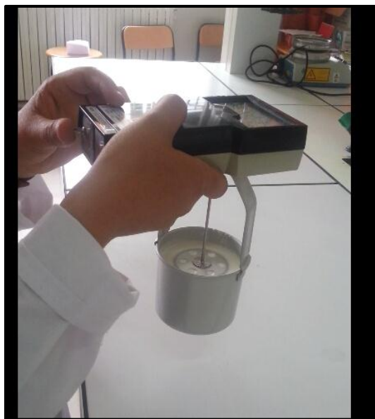
Figure N°18 A: la détermination de viscosité (photo originale)
