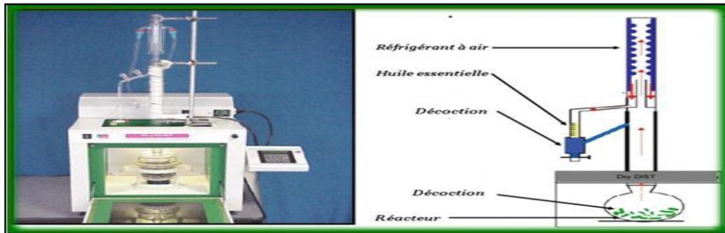
Figure 5: Montage d'une extraction assistée par micro-onde (Boutamani, 2013)
