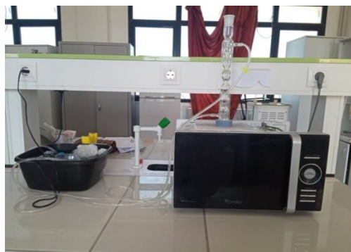
Figure 6: Appareil de MAE utilisé lors de l'extraction de composés phénoliques
