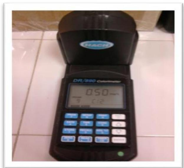
Image d'un appareil de Chlorométrie
