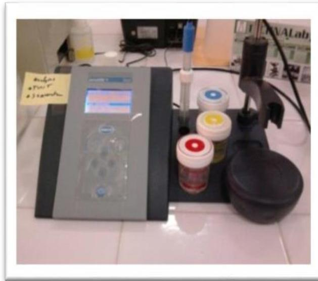
Image d'un appareil de pH-mètre.
