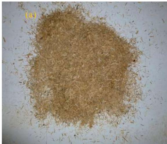
**Figure1. 3** Fibres de bambou traité par NaOH(Yan et al., 2016).
