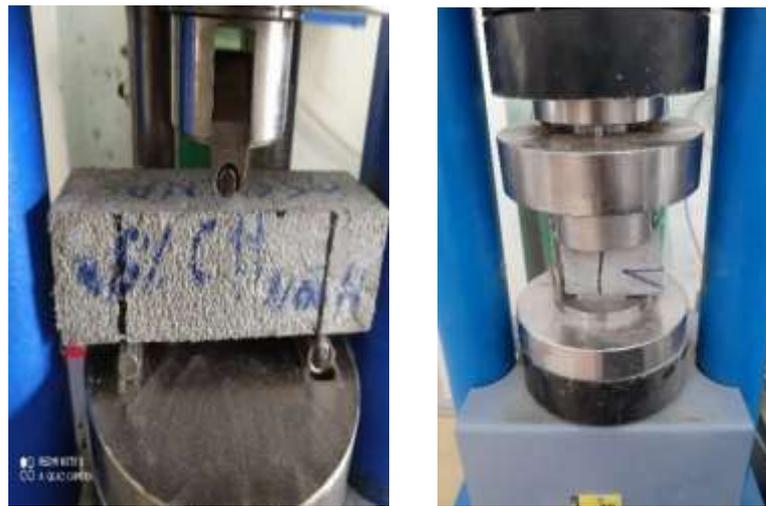
**Figure2. 7** Appareilles de l'essai de compression et de flexion.
