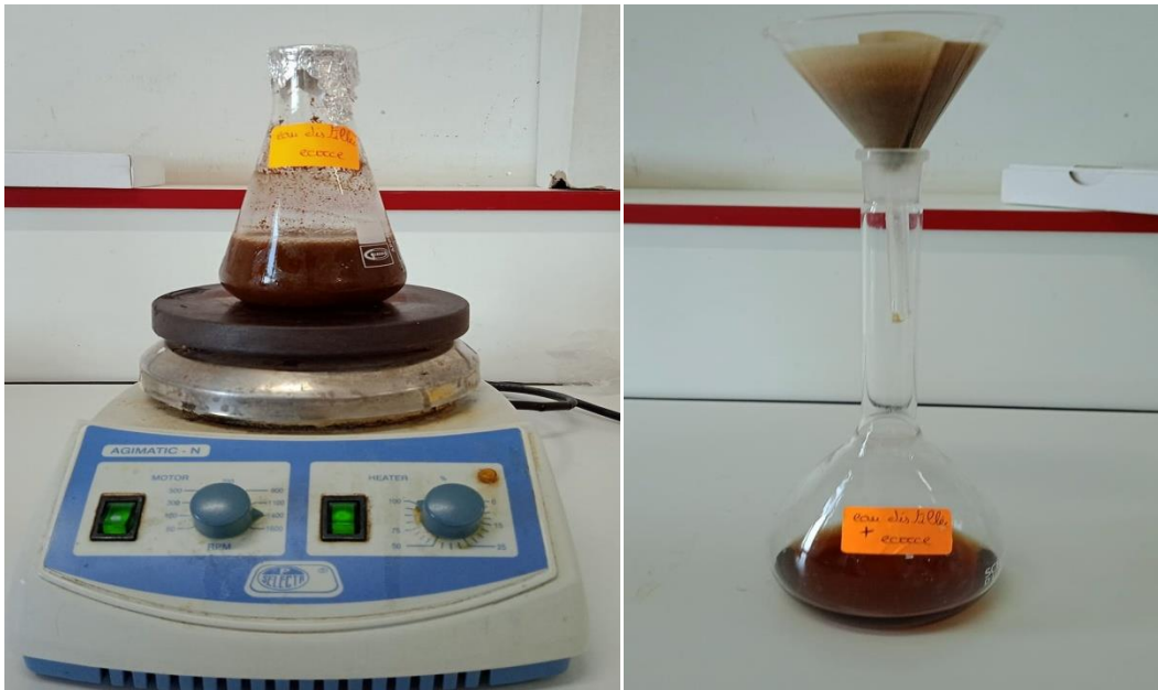
Figure 5 : Extraction par macération.
