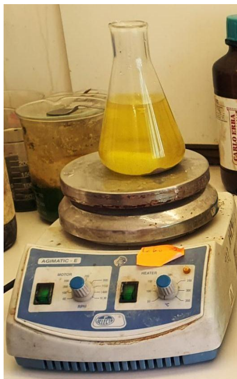
Figure III.5 : Dissolution de \text{PbO}_2 dans un milieu acide.
