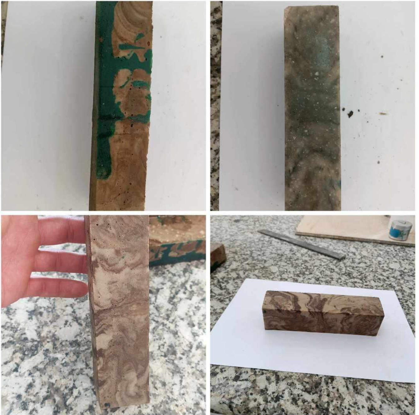
Figure 1 Echantillon d'un faux marbre réalisé dans le laboratoire de génie civil université de BBA
