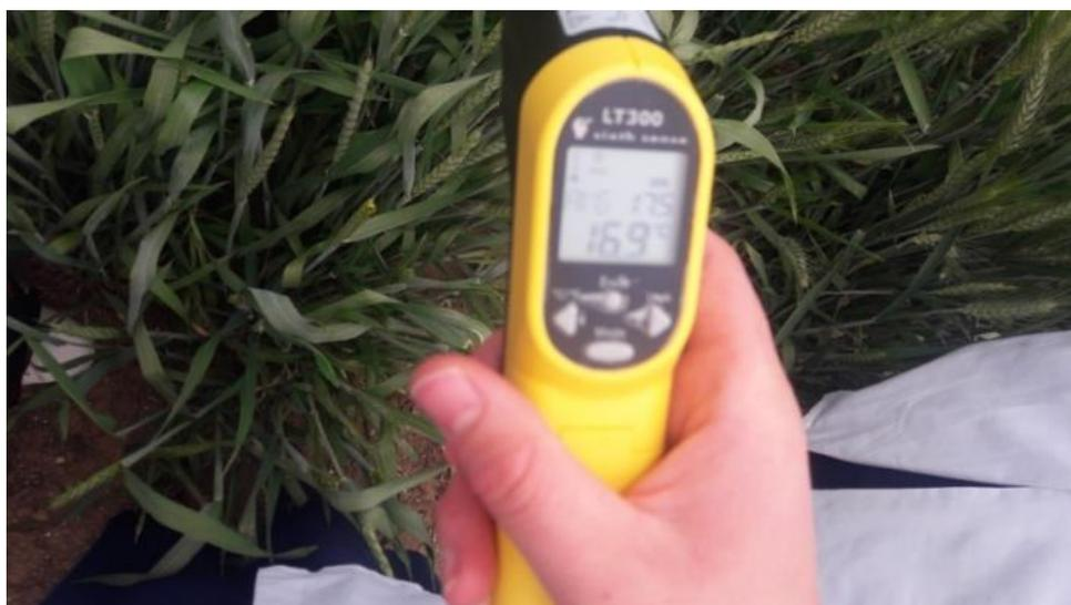
**Photo 4 :** Lecture de la température du couvert végétal par le thermomètre portable.
