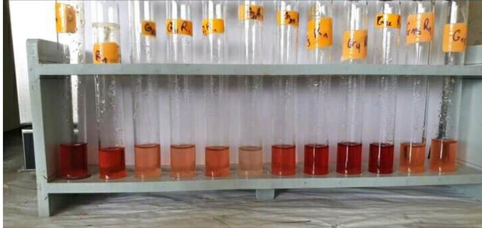
**Photo 6 :** Tube à essai de quelques échantillons, contenant de la proline colorée en rouge.
