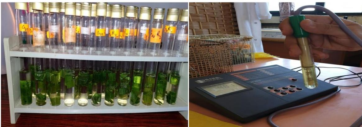
**Photo 3 :** Des échantillonnées de feuilles placées dans des tubes à essai remplis de 10 ml d'eau distillée (à gauche) et lecture de la conductivité par conductimètre (à droite).
