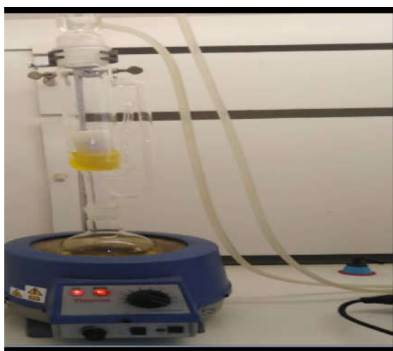
Figure 05 : Extraction de l'huile par Soxhlet
