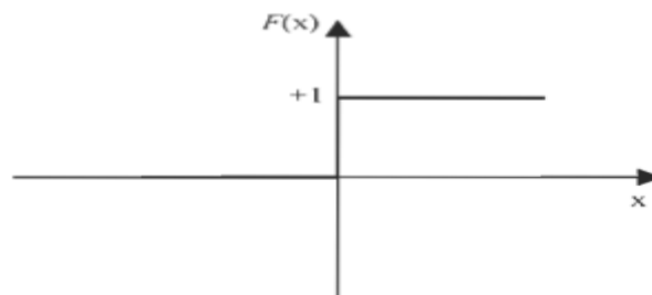
Figure 2.4.3.2 : Fonction d'activation binaire à seuil.
