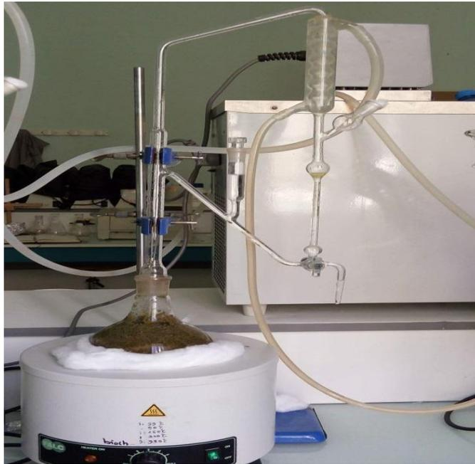
**Figure 02.** Dispositif d'extraction par hydrodistillation (Appareil de type Clevenger)
