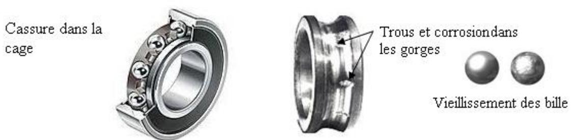
Figure.I.7. Différentes défaillances des roulements à billes
