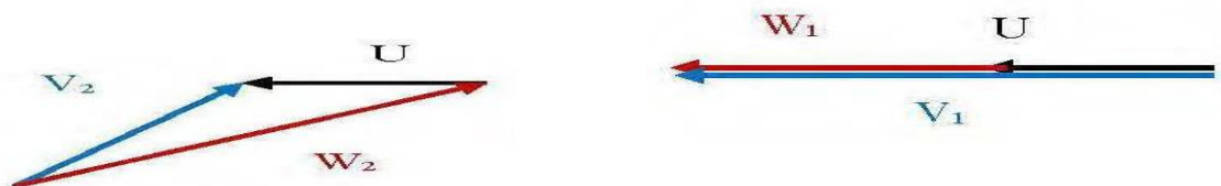
Figure 1. 14. Triangles des vitesses dans une roue d'une turbine Pelton [10]
