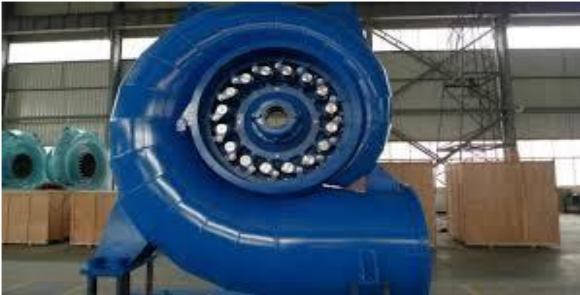
Figure 1. 12. Bâche de la turbine [7].
