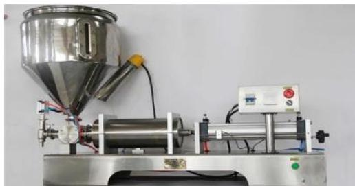
Figure I. 4. Machine de remplissage semi-automatique.
