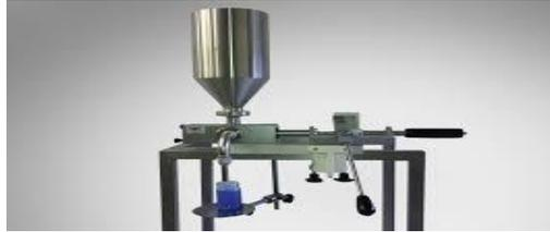
Figure I. 5. Machine de remplissage manuel.
