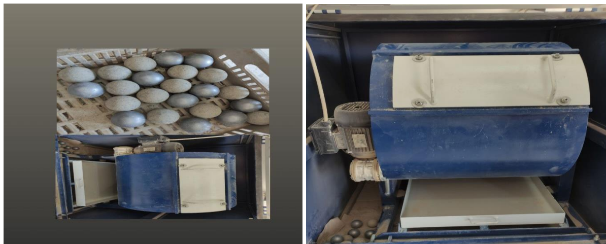
Figure III.4 : L’échantillon et les boules avant l’essai Los Angeles (Appareille Los Angeles)
