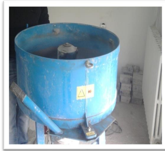
Figure II.1 : Machine de malaxage du béton
