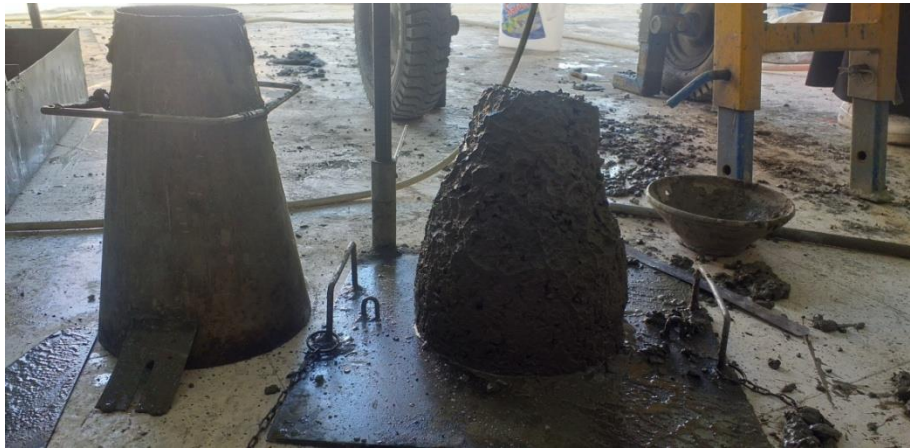
Figure VI.1 : Essai d'affaissement au cone d'Abrams
