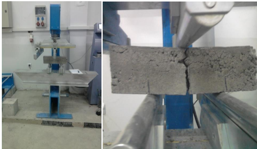
Figure II.9 : Essai de traction par flexion.
