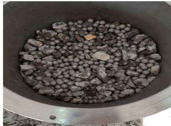
Figure III.6 : L'échantillon avant l'essai (Micro Deval)
