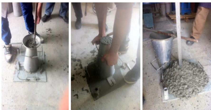
Figure II.3 : Mesure d’affaissement au cône d’Abrams.
