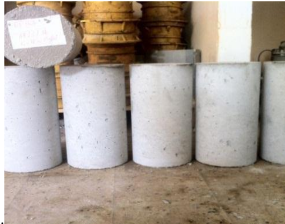
Figure II.6 : Epreuves cylindrique de diamètre 16 cm et de hauteur 32 cm.
