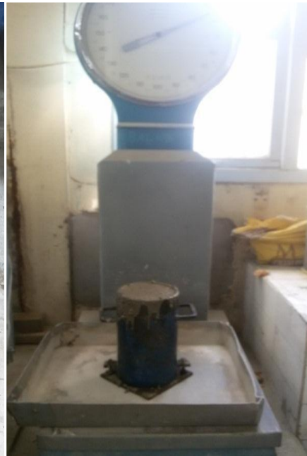
Figure II.5 : Mesure de la masse volumique à l'état frais
