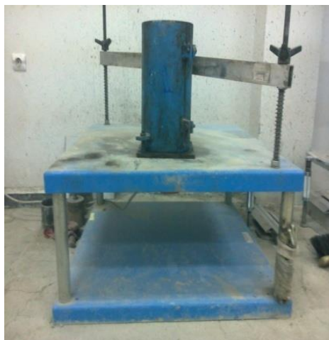
Figure II.2 : Vibration de béton par la table vibrante
