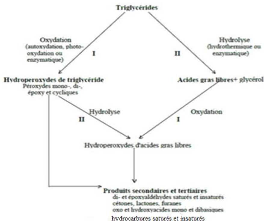
Figure I-17 : Différentes réactions de dégradation des huiles végétales.
