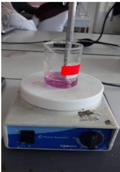
Figure III-41 : Avant le point d'équivalence par HCl (0.1N).
