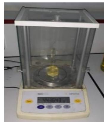
**Figure III-6 :** Mesure de pycnomètre rempli avec l'huile.
