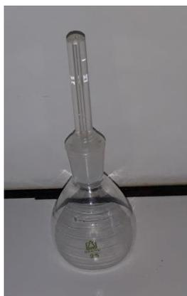
Figure II-1 : Pycnomètre.
