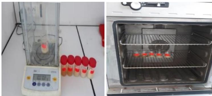
Figure III-39 : Détermination de taux d'humidité des savons mous.
