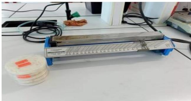
**Figure III-29 :** La mesure du point de fusion des savons solides à chaud et à froid.
