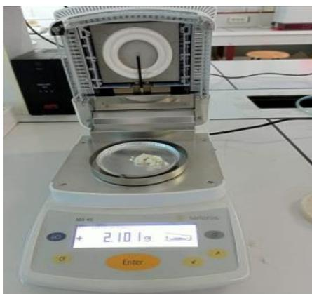
Figure III-36 : Dessiccateur humidité.
