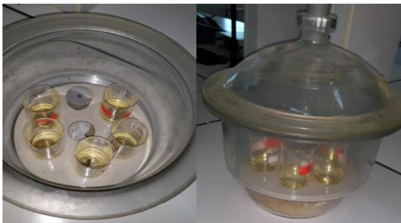
Figure III-12 : Les huiles refroidies dans le dessiccateur.
