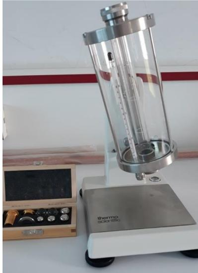
Figure II-2 : Viscosimètre.
