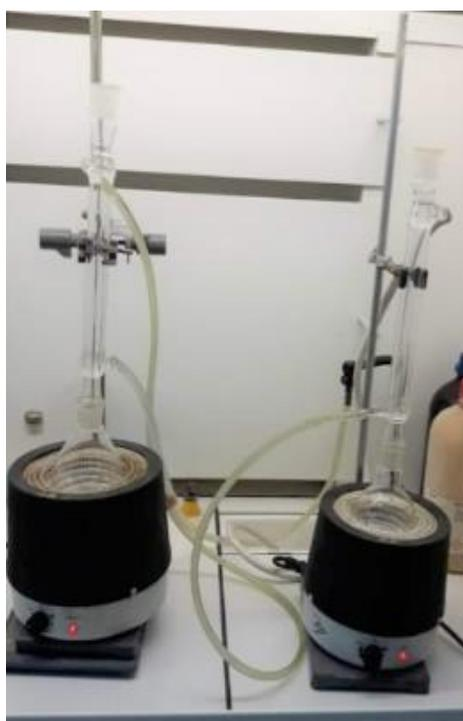
**Figure III-17 :** Montage à reflux de l'indice de saponification.
