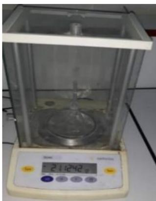
**Figure III-5 :** Mesure de pycnomètre vide.
