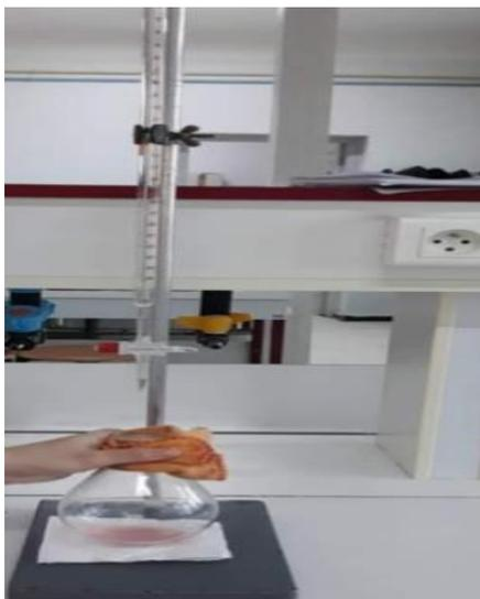
**Figure III-18 :** Dosage de mélange avant le point d'équivalence.
