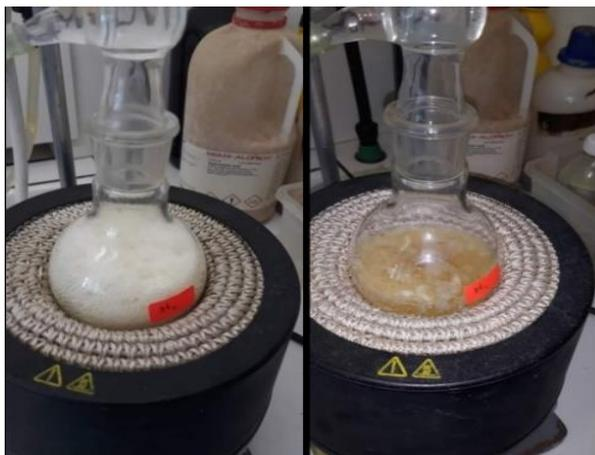
Figure III-21 : Montage à reflux de saponification à chaud.
