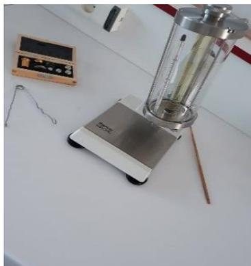
Figure III-9 : Viscosimètre à chute bille.
