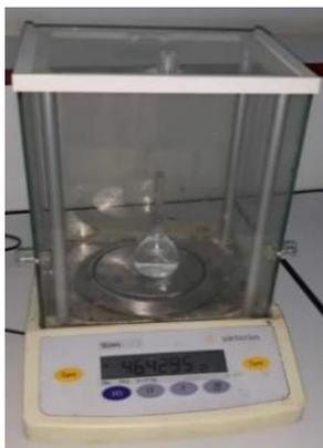
Figure III-7 : Mesure de pycnomètre rempli avec l'eau.
